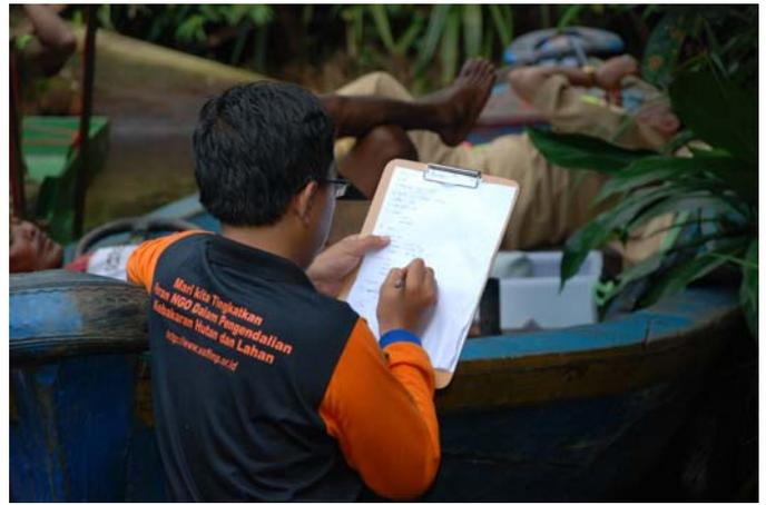
Tim survey sedang melakukan pencatatan kecepatan aliran air kanal/parit. Pengukuran waktu tempuh yang dilakukan di lapangan adalah dengan memastikan bola pingpong melayang (hanyut) dari titik nol sampai ke batas titik 50 m tanpa hambatan.
