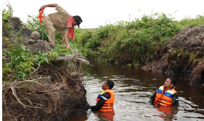
Tim survey sedang melakukan pengukuran tinggi permukaan air di kanal/parit dari atas lantai gambut dan dari dasar kanal. Pengukuran dilakukan pada setiap kanal/parit yang dijumpai di lapangan.
