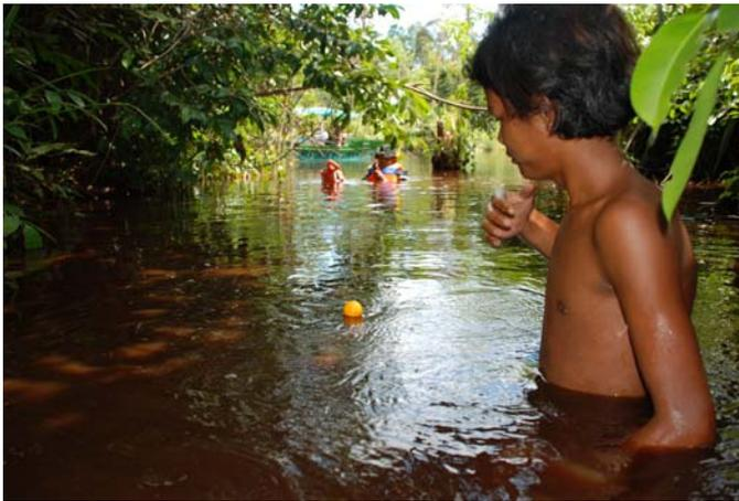
Salah seorang dari tim survey sedang melakukan pengukuran kecepatan aliran air di alur kanal/parit dengan menggunakan Bola Ping Pong.
