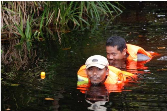
Pengukuran kecepatan aliran air dengan menggunakan Bola Pingpong. Pencatatan waktu yang diperlukan untuk bola hanyut menuju titik 50 m dengan menggunakan stop watch (detik).
